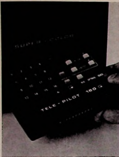
Bild 5. Mit dem Geber der Infrarot-Fernsteuerung können 16 Programme in Direktwahl sowie eine Reihe anderer Funktionen gesteuert werden, auch die eines angeschlossenen Video-Recorders
