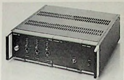
Bild 5. Dieses 19"-Gehäuse enthält die gesamte „Indoor Unit“
